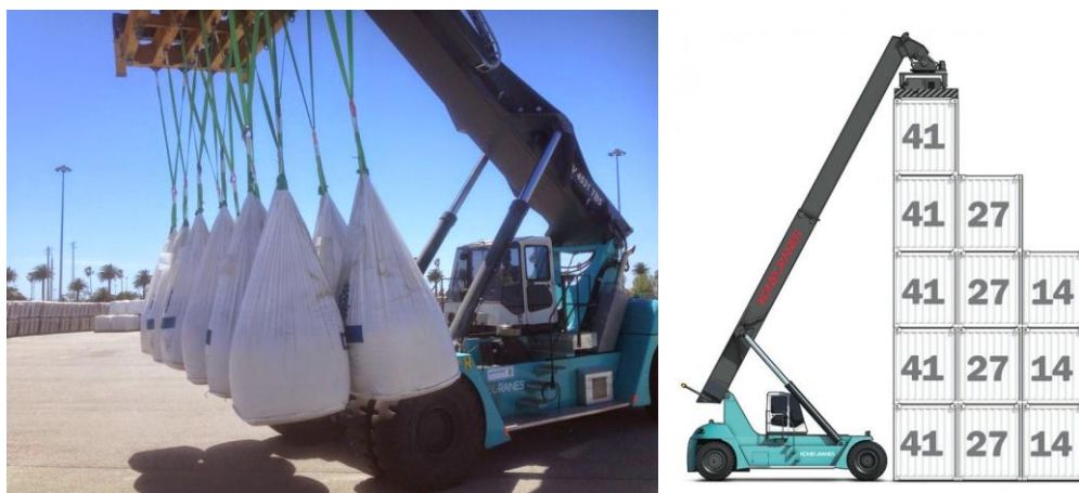
Figura 96 - Grua móvel multifunções, KoneCrane SMV 4531 TB5, com capacidade de elevação de 14 a 41 toneladas, em trasfega de “big bags” no porto de Aveiro
